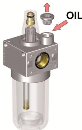
Um das Öl nachzufüllen, lösen Sie den Öleinfüllstoppfen auf der Oberseite vom Öler oder indem Sie den Behälter unten lösen und auffüllen (im drucklosen Zustand). Die Ölmenge regulierung erfolgt über eine Einstellschraube mit einem Schraubenzieher und setzt einen Tropfen Öl auf 300-600 NI/min. frei.
