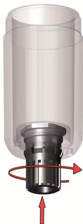
Der manuell / automatische Kondensat- ablass öffnet sich sobald der Behälter drucklos ist. Somit kann das Kondensat automatisch abgelassen werden. Unter Druck kann man den ganzen Vorgang manuell betätigen, um das Kondensat abzulassen.
